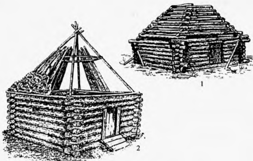
Рис. 27. Конструкция квадратных срубных жилищ-иб: 1 – хакасы-кызылыцы, 2 – алтайцы. По А.А. Попову (1961. Табл. XXI, 1, 2).
