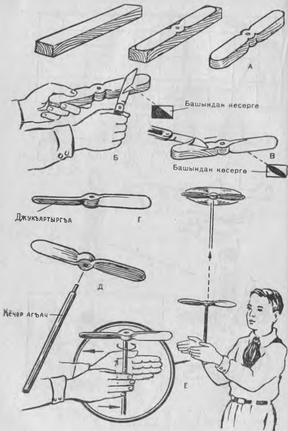
113 сур. «Муха» вертолетну модели: харифле оюнчакъны къалай джыйылыб барлыгын кѣргюзедиле.
