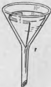
75 сур. Къагъыт сюзгюч: харифле бла аны хазырлау джорукъ кергюзюлгенди.
