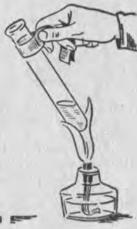
180 сур. Къагъыт кесекчикни болушлугъу бла пробирканы къалай тутаргъа боллукъду.
