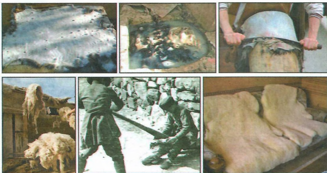
Операции по обработке кожи: засолка, дубление, очистка, разминание. Справа внизу готовая продукция
